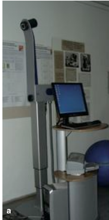
Abb. 2a-c: Projektor-Kamerasystem der Videorasterstereographie (Formetric®-System) als Kompletanlage (a), mit den optischen Systemen (b) LED-Kamera (oben) und Rasterprojektor (unten) und angeschlossener Beinlängenausgleichsplatform (c).
